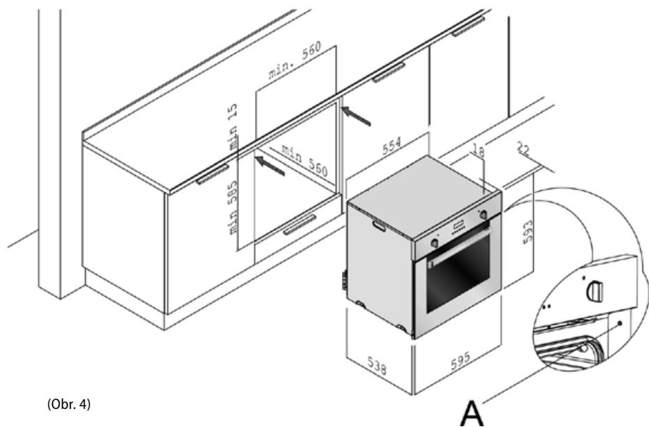
3. Spotrebič nasuňte na kraj skrinky a prestrčte prívodný kábel cez zadnú stenu skrinky tak, aby bola po inštalácii prístupná jeho zástrčka.
